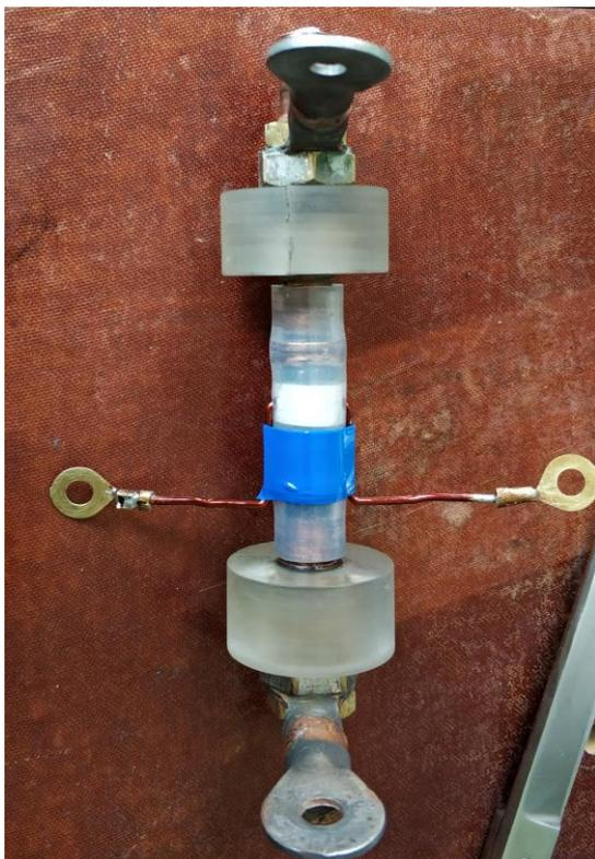
Медные электроды вставлялись в просверленные отверстия в фторопластовой втулке и доходили до центрального отверстия, не высовываясь во внутрь.
