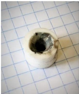
Электролит – 2 литра бидистиллята + 20 гр NaOH. Боковые электроды – медная эмалированная проволока диаметром 2 мм; трубчатые – титановые наконечники, слегка конически заточенные.
