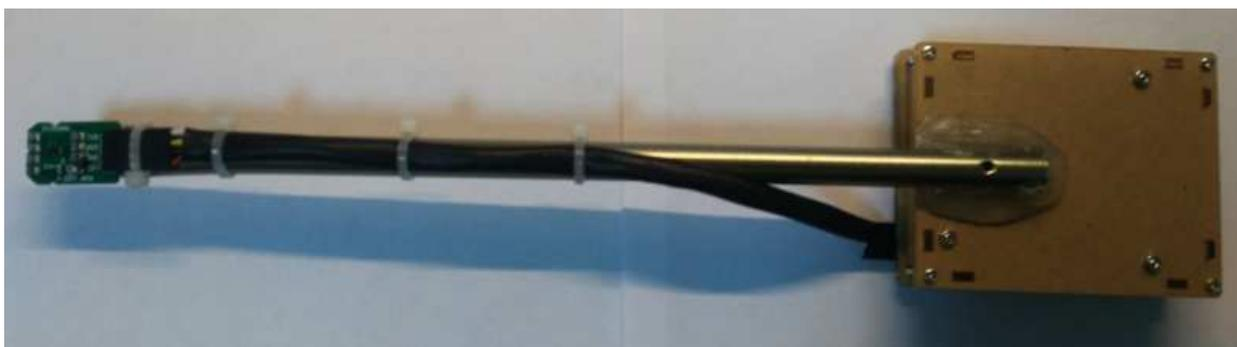
Рис.37. Измеритель напряженности магнитного поля **АЕМ-1.000 mT**.
