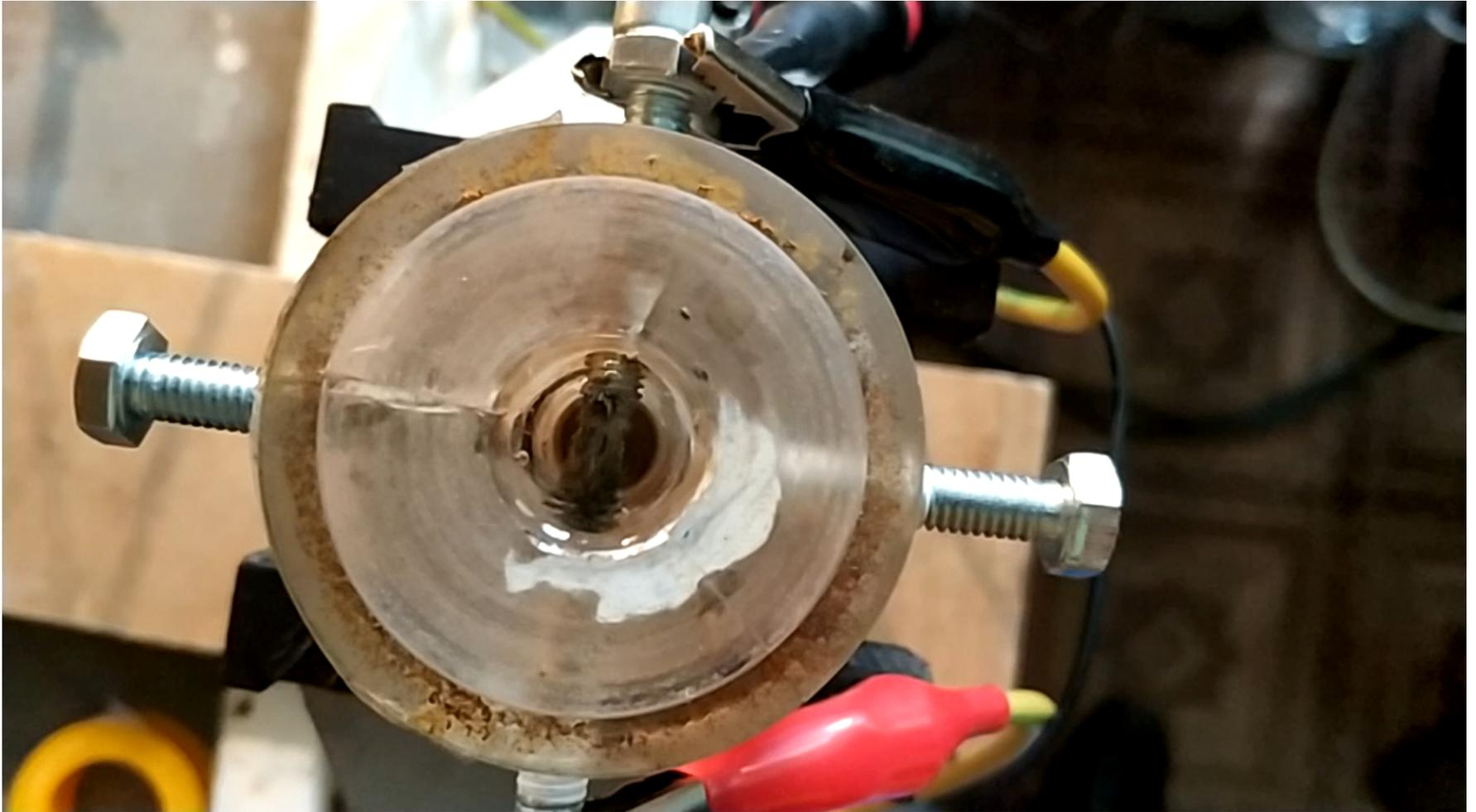
Замедленное видео сделано в конфигурации ячейки с боковыми электродами с применением порошка никеля и водопроводной воды.
