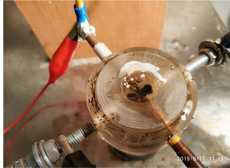
В четырехэлектродной конфигурации ячейки с применением порошка карбонильного и водопроводной воды образовалось необычное вещество, по внешнему виду напоминающее полимер. Образовался на стенке ячейки из полиметакрилата и имел плотность меньше воды. Состав образования не исследовался.
