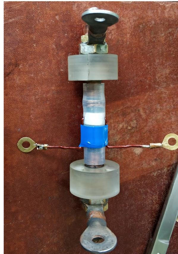
Эксперимент с медными электродами и фторопластовой конической вставкой. Электролит – 10 гр LiOH на литр дистиллированной воды.
