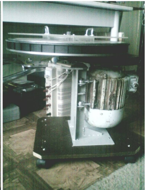
Опытная модель на пусковом блоке с усиленной турбиной и двигателем 3 кВт
