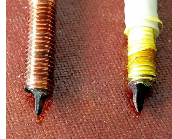
Боковые электроды после работы в данном режиме.
