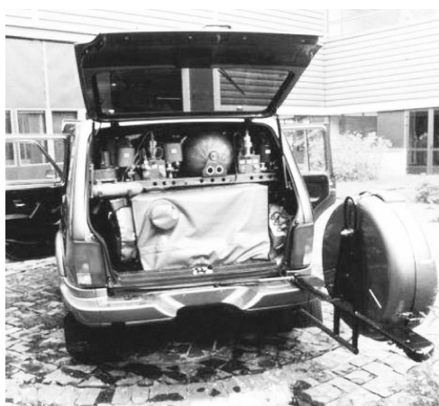
Рис. 13.9. Водородная энергетическая установка сейчас занимает весь багажник «Лады»
