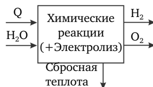
Рис. 5.2. Принципиальная схема термохимического разложения воды
