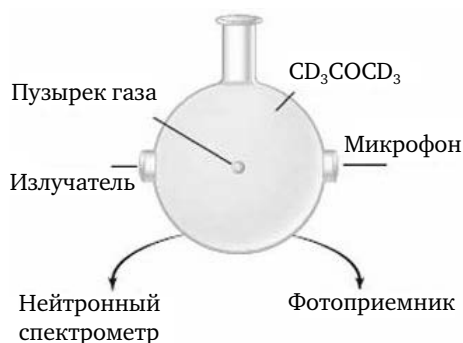
Рис. 6.9. Схема установки Талейархана
