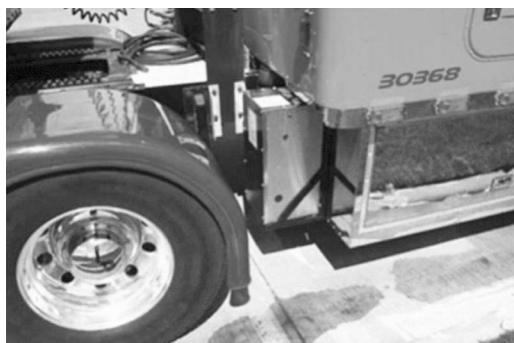
Рис. 13.4. «Бортовой генератор водорода» (небольшая коробка справа от колеса)
