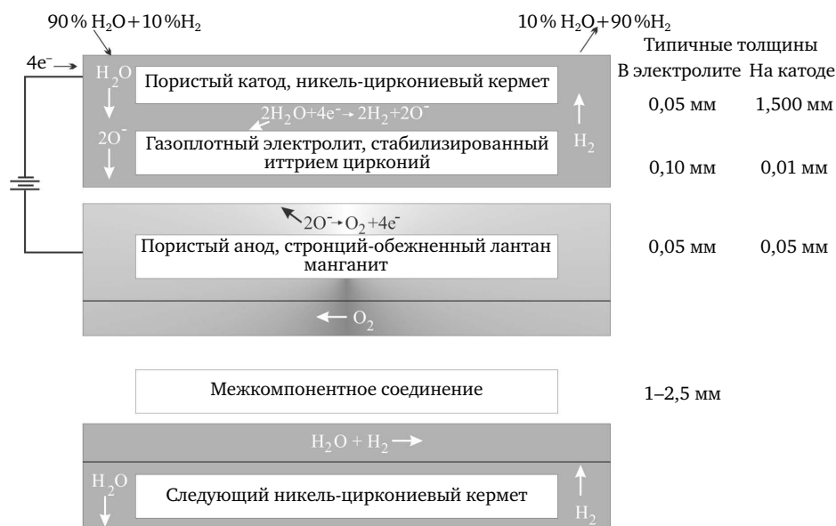
Рис. 5.1. Общая конфигурация ячейки электролиза на твердом оксиде
