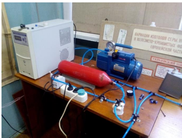
Пневматическая система-генератор водорода, вакуумный насос, буферная емкость для водорода, быстросъемные соединительные фитинги.
