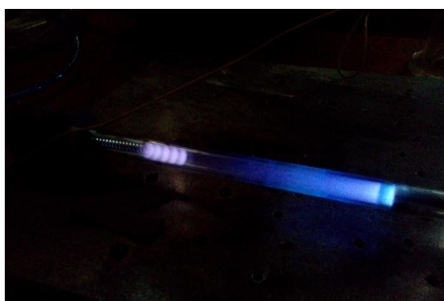
Тлеющий разряд в кварцевой трубе диам.20мм.
