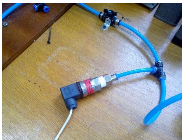
Претензионный датчик давления в системе.
