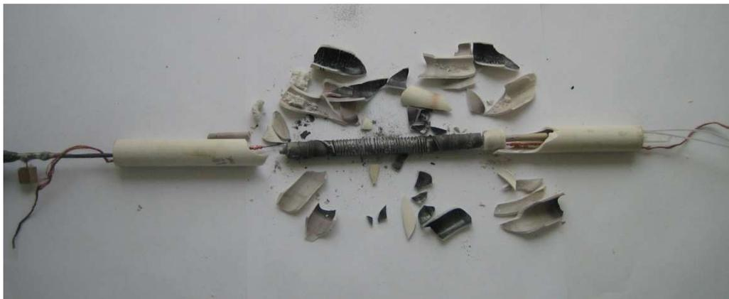
Рис. 3. Реактор 'Проток 6' после вскрытия.
