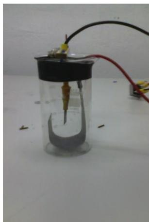
и именно на электроде с малой активной поверхностью благодаря высокой плотности тока и образуется парогазовый пузырь в котором возникает дуговой разряд ионизирующий газ с образованием «пульсирующей» плазмы и создаются условия подходящие для активации ХЯС.
