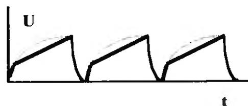
Рис.6. Типичная осциллограмма напряжения на разряднике. Сплошная кривая - эксперимент; пунктирная кривая - экспоненциальный теоретический рост.
