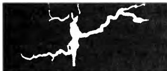
Рис.4. Формирование плазмOIDных структур при атмосферном давлении при организации подачи воздуха (газа) в область факела.
