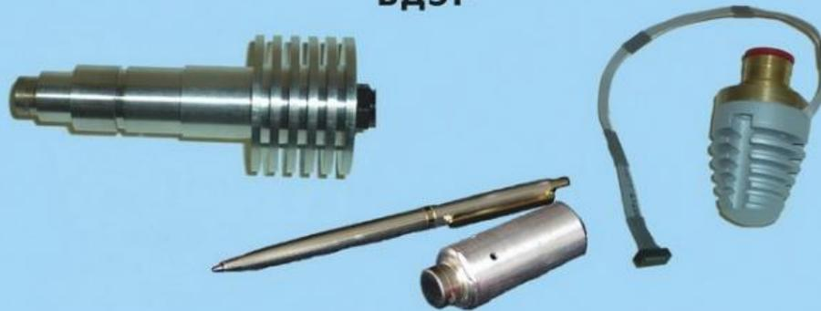
Блоки детектирования (БДЭР) предназначены для регистрации и спектрометрии рентгеновского излучения.
