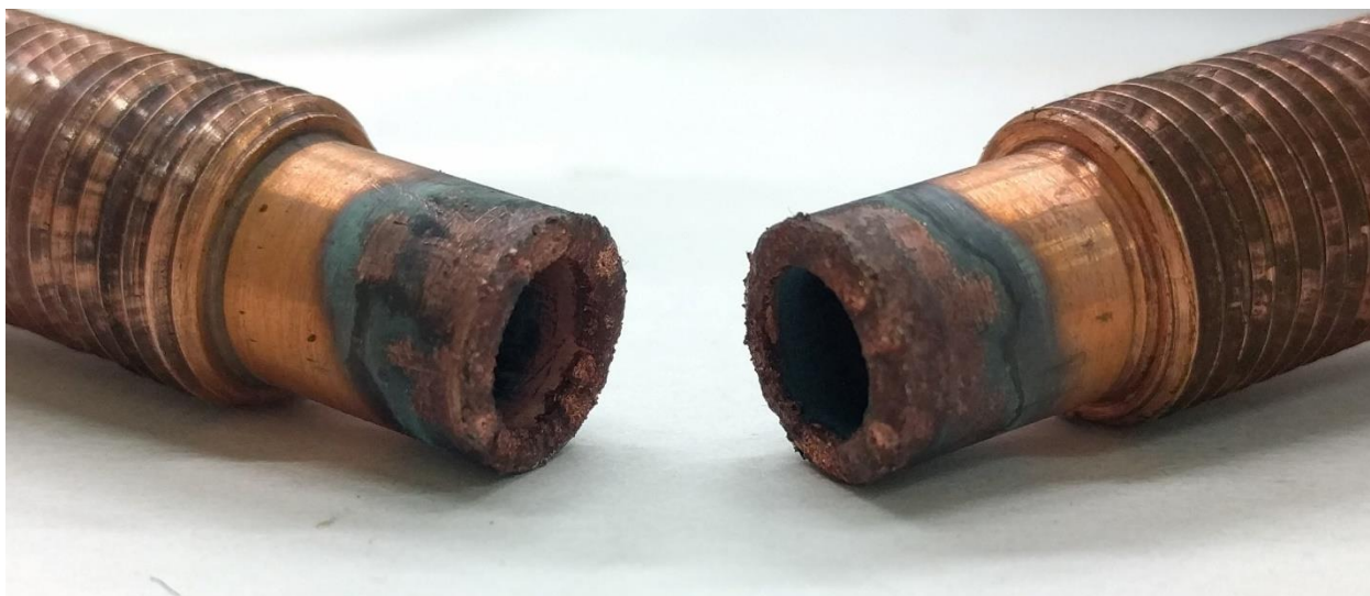
Внешний вид медных электродов после 6 минут работы реактора с катушкой «Брукса».
