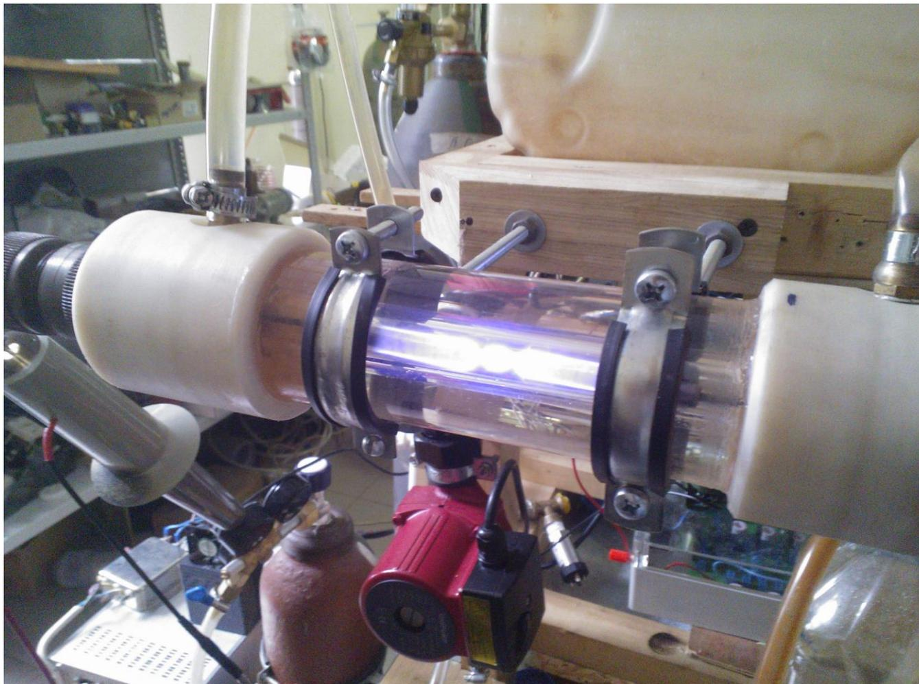
Что предлагается: использовать простую установку тлеющего разряда, выполненную из двух коаксиально расположенных кварцевых трубок. Выделяющееся тепло отводится водой и ее кол-во измеряется по разности температур до и после эксперимента.
