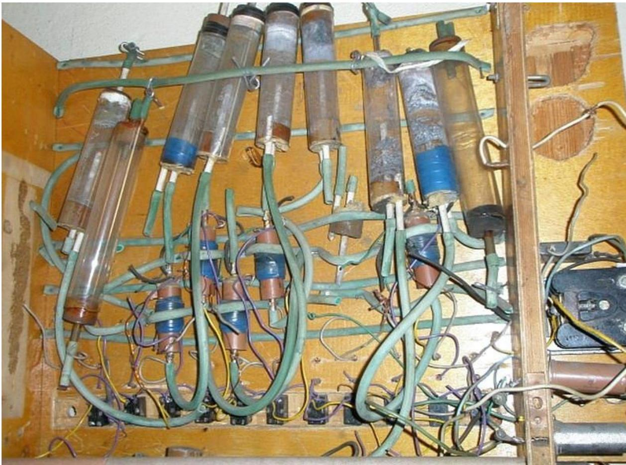
Для лабораторных работ по водно-плазменной обработке растворов был создан действующий стенд (фото 2006 года).
