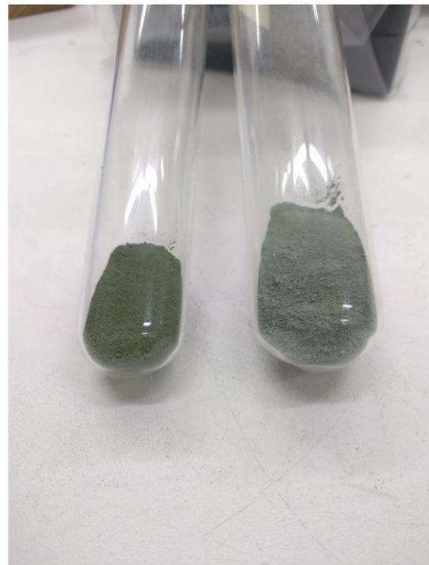
Раствор сливался в емкость, отстаивался, осадок высушивался на воздухе. Некоторые экземпляры осадка хорошо притягивались постоянным магнитом. Было отмечено, что наличие катушки на реакторе влияет на количество порошка и содержание в нем ферромагнитных включений. Кроме осадка генерировалось большое количество газа, преимущественно это гремучий газ, точный состав определить не было возможности.
