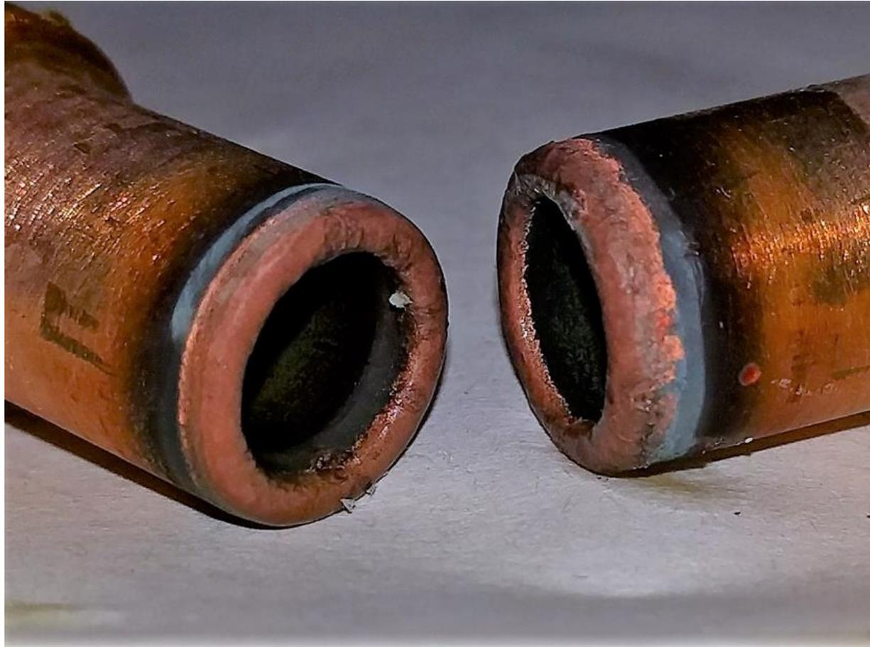
Очевидно, что часть меди с электродов перешла в раствор в виде мелкодисперсного порошка, который легко выделяется путем отстаивания и фильтрации. По сравнению с оригинальной установкой Энергинива в данном эксперименте не был достигнут желаемый режим, при котором происходит наработка элементов в значительно больших масштабах и при отсутствии искровых разрядов, разрушающих электроды.
